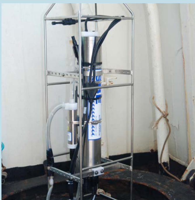
Sonde CTD mesurant les paramètres de température, conductivité et pression © Bertrand A., IRD
