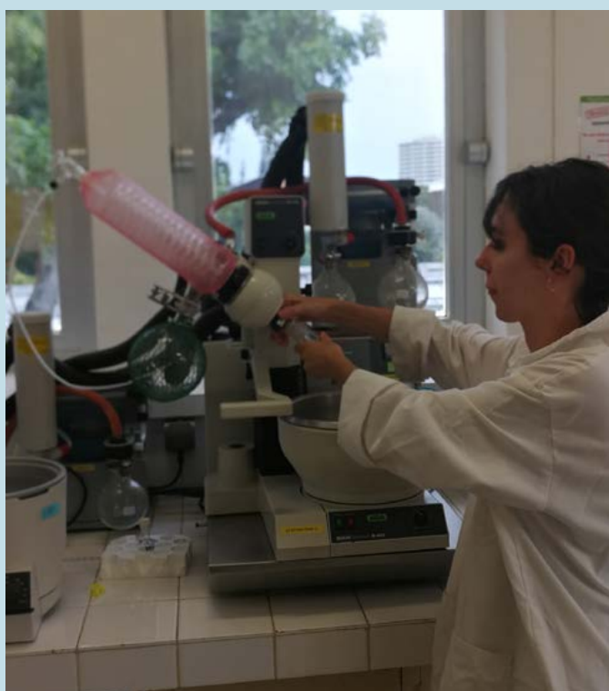
Étape d'extraction des molécules organiques par évaporation (Rotavapor®) © AEL
