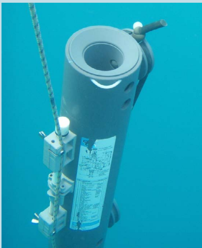
Bouteille de prélèvement GoFlo™ pour le dosage des métaux dissous © AEL
