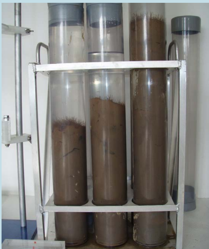
Exemple de carottes obtenues avec des tubes de 60 cm © AEL
