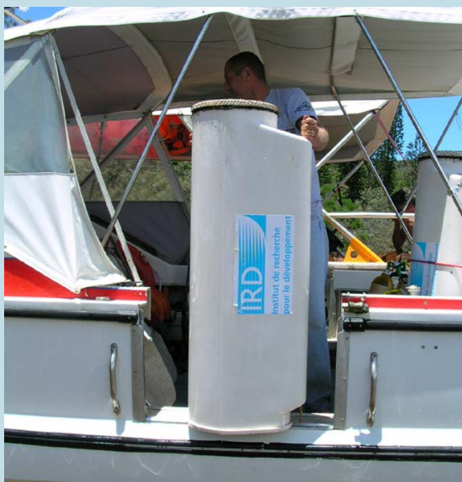
Pièges à sédiments de type séquentiel à 12 godets programmables © IRD
