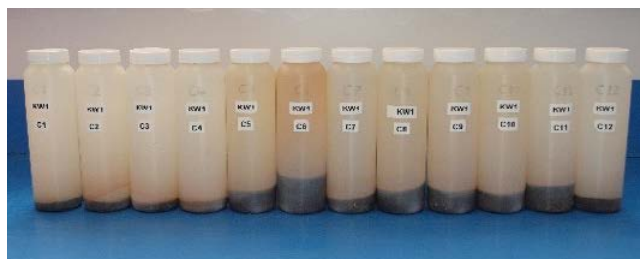
Série de 12 godets décrivant une collecte séquentielle des matières en suspension © AEL
