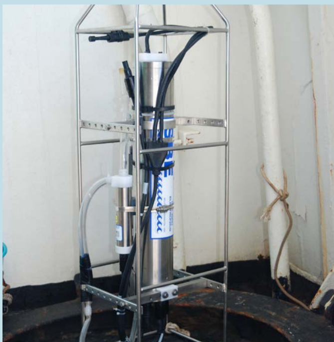
Sonde CTD mesurant les paramètres de température, conductivité et pression © Bertrand A., IRD
