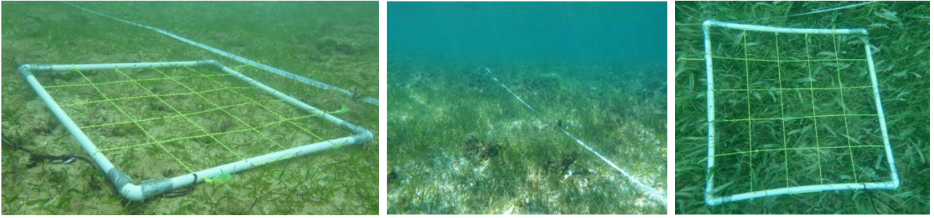
Figure 8.16 : Illustration du positionnement des quadrats (50 x 50 cm) le long des transects (© Kerninon F., UBO)
