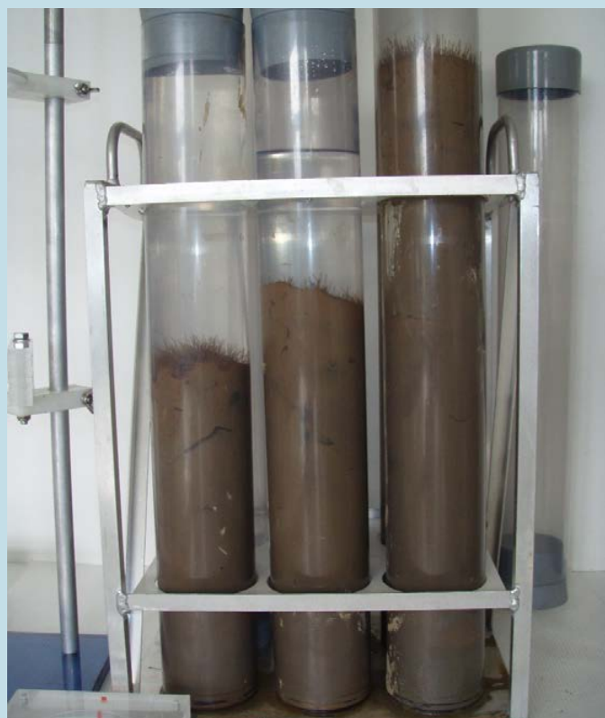
Exemple de carottes obtenues avec des tubes de 60 cm © AEL
