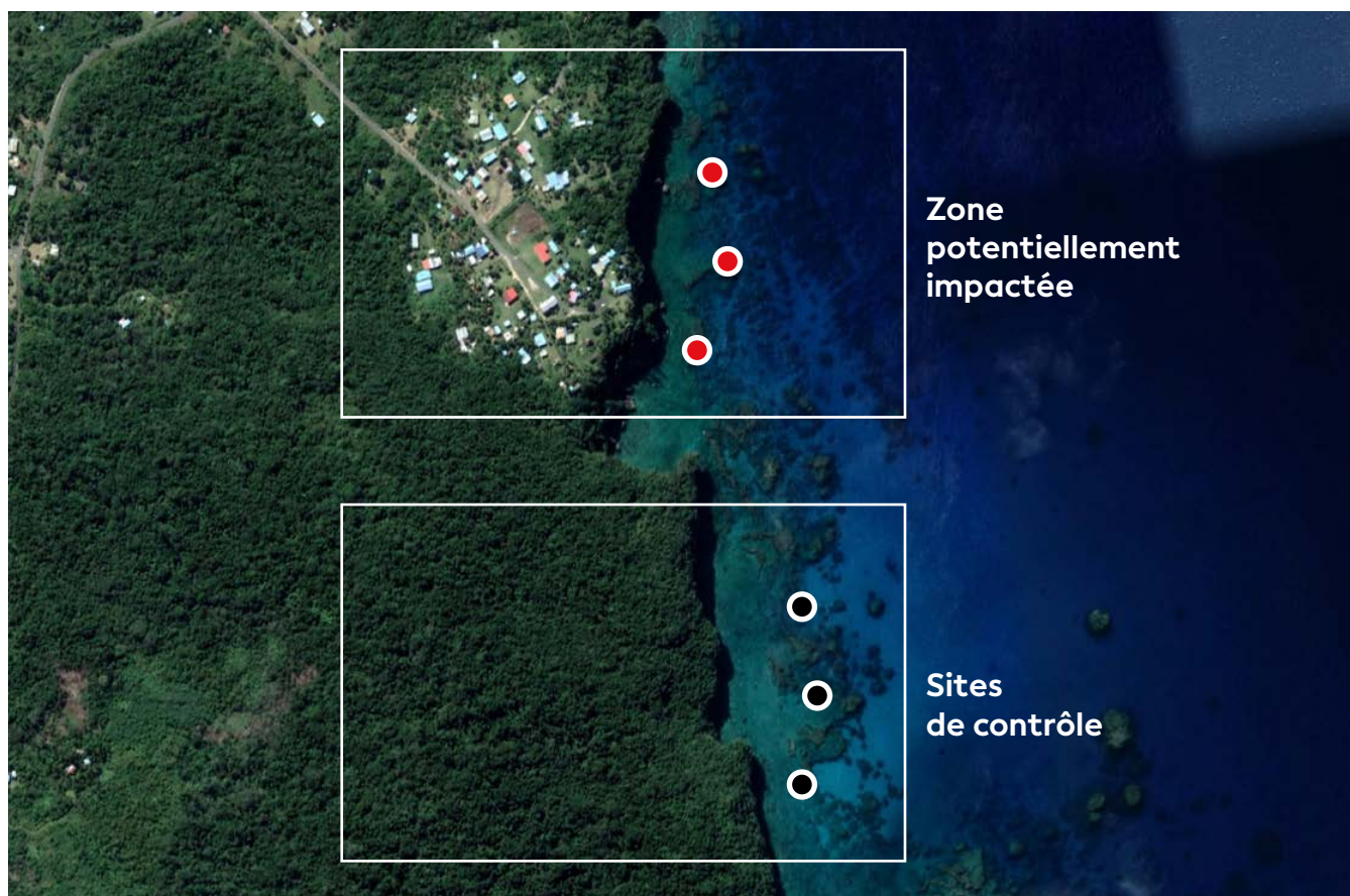
Figure 4.5 : Positionnement des points d'échantillonnage d'un BACIPS avec trois points dans la zone subissant la pression, et trois points de contrôle dans la zone ne risquant pas d'être impactée (zone aux caractéristiques géomorphologiques, courantologiques et biologiques proches de la zone d'impact, pour éviter les facteurs de confusion)
