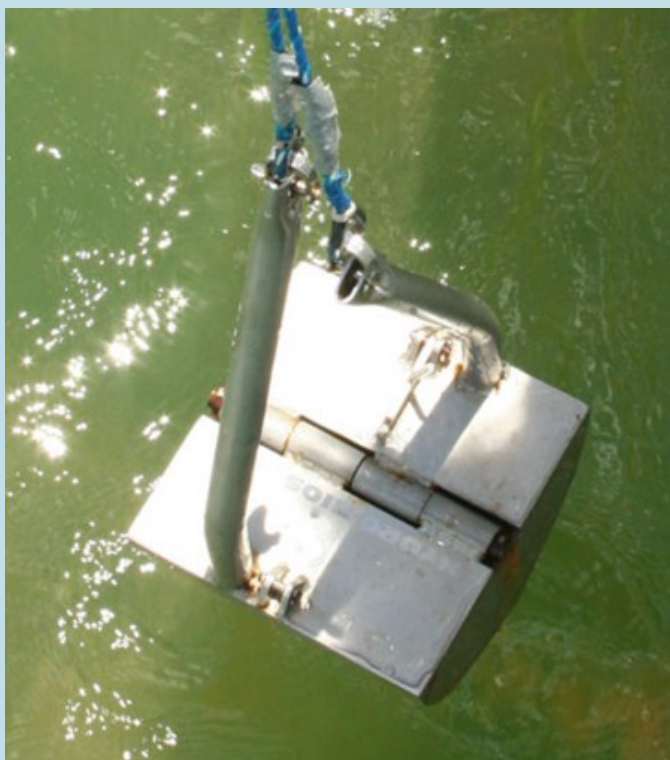
Benne de prélèvement des sédiments : type Van Veen en acier inoxydable nuance 316L © AEL
