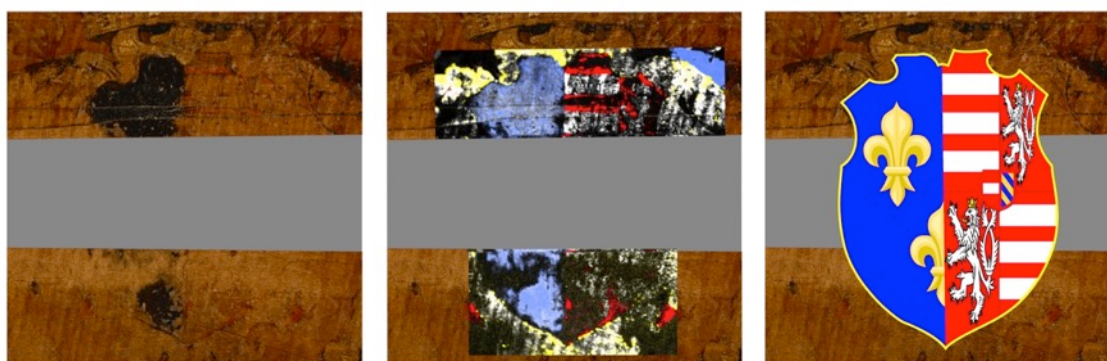
Fig. 4 : a) Zone centrale du fond de la basse de violon d'Andrea Amati (musée de la Musique, E.2020.1.1), intégrant (en gris) la zone supprimée lors de la recoupe en violoncelle ; b) Cartes de détection par fluorescence X des éléments cobalt (en bleu), du mercure (en rouge), de l'or (en jaune) et du fer (en blanc) ; c) Proposition de reconstruction schématique des armoiries initialement peintes.
