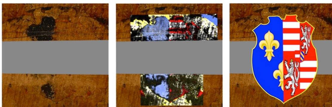
*Fig. 4 : a) Zone centrale du fond de la basse de violon d'Andrea Amati (musée de la Musique, E.2020.1.1), intégrant (en gris) la zone supprimée lors de la recoupe en violoncelle ; b) Cartes de détection par fluorescence X des éléments cobalt (en bleu), du mercure (en rouge), de l'or (en jaune) et du fer (en blanc) ; c) Proposition de reconstruction schématique des armoiries initialement peintes.*
