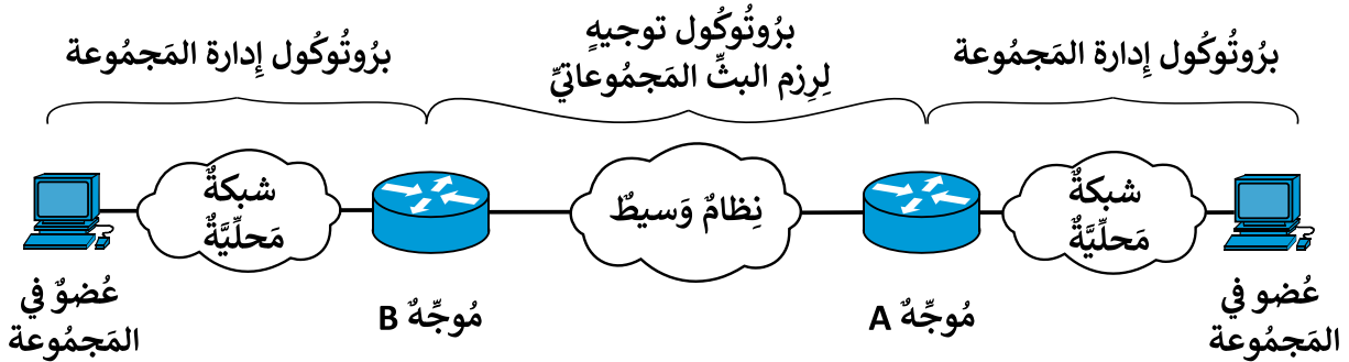
الشكل (2-5): بنية شبكة بيانات تدعم البث المجموعاتي
