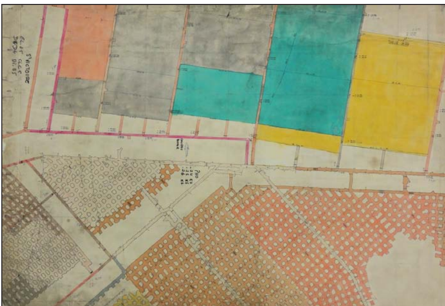
Fig. 31. [Plan d'exploitation dans les quartiers Sainte-Victoire et Regagnas], n.d. [1980] (BRGM UTAM SUD : CdF/C3 Vt1/22). Détail. Repro. T. Lochard. Exploitation par chambres et piliers au sud, et par longue taille au nord.
