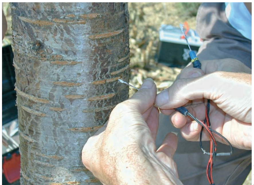
Installation des capteurs de flux de sève sur un merisier.
