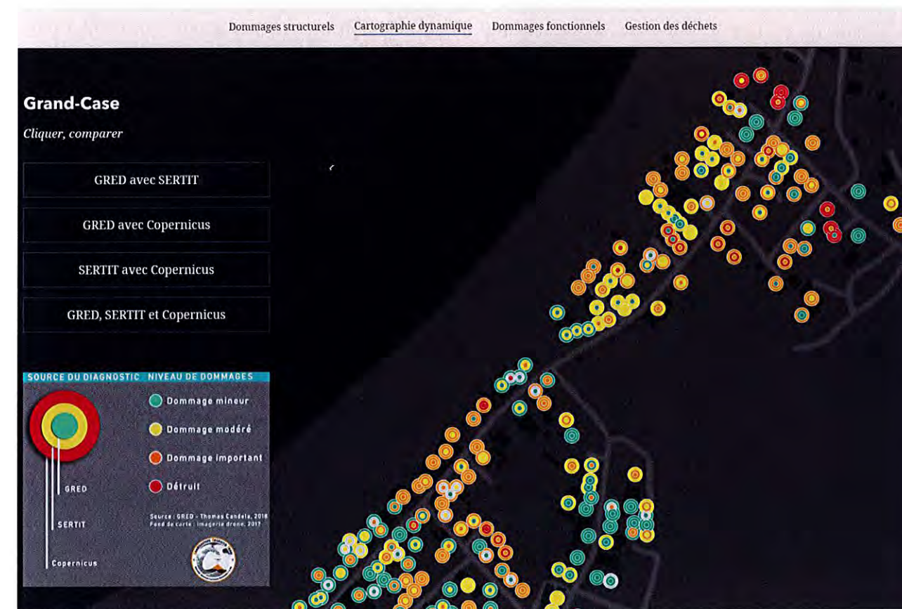
Figure 4 : Capture d'écran de la StoryMap "Les infrastructures à l'épreuve d'Irma", exemple de la carte dynamique de présentation des dommages au bâti sur le quartier de Grand-Case (source : https://arcg.is/eKq4C )
