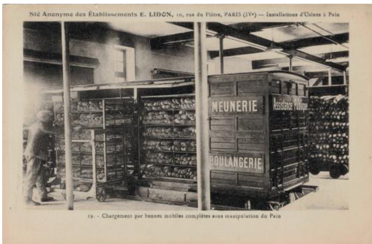
Figure 48 : Sté. Anonyme des établissements E. Lidon, 10 rue du Plâtre, Paris (Ive). Installations d'usines à pain. 19- Chargement par bennes mobiles complètes sans manipulation de pain. © Coll. JP Martin.
