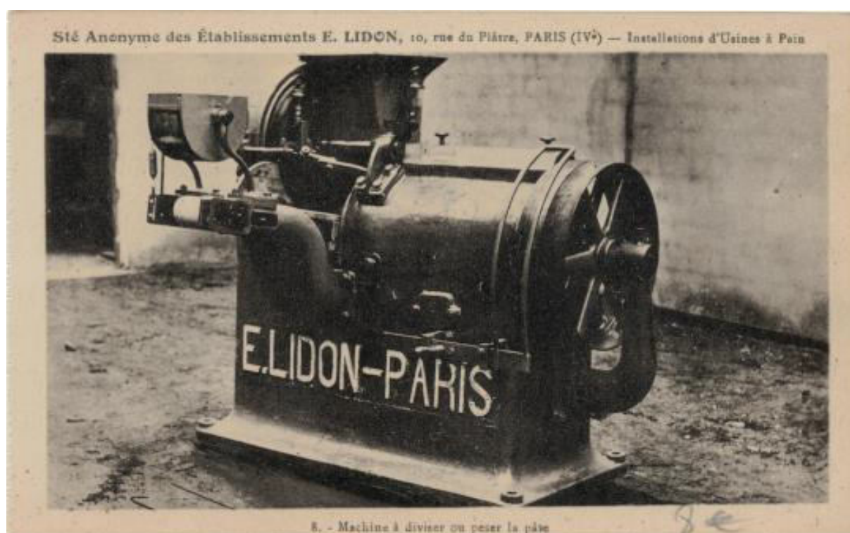
Figure 40 : Sté. Anonyme des établissements E. Lidon, 10 rue du Plâtre, Paris (Ive). Installations d'usines à pain. 8- Machine à diviser ou peser la pâte. © Coll. JP Martin.
