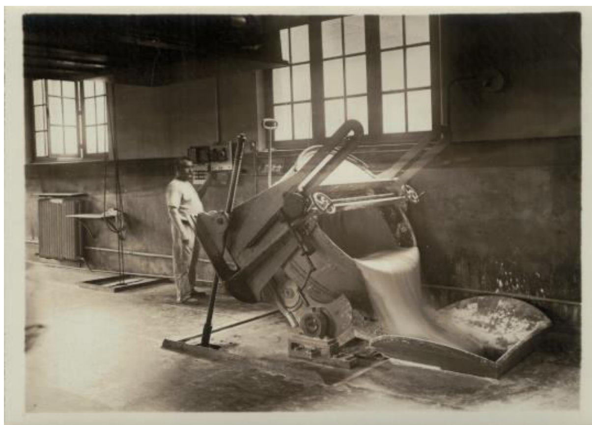
Figure 35 : Boulangerie industrielle de l'Assistance publique, 12 rue de la Collégiale, Paris Ve. Basculeur de cuve. Cliché identique à la carte ci-dessus (Figure 35). Cliché pris en mars 1927 par la Société du Petit Parisien, Dupuy et Cie, 16-22 rue d'Enghien, Paris.
