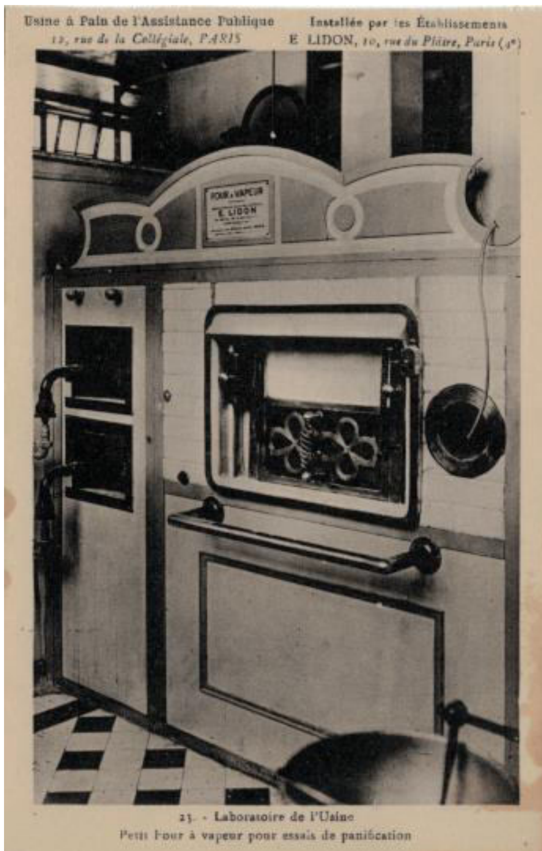
Figure 52 : Carte postale ancienne. Usine à pain de l'Assistance Publique, 12 rue de la Collégiale, Paris. Installée par les établissements E. Lidon, 10 rue du Plâtre, Paris (4e). 12 - Laboratoire de l'usine. Petit four à vapeur pour essais de panification. © Coll. JP Martin.
