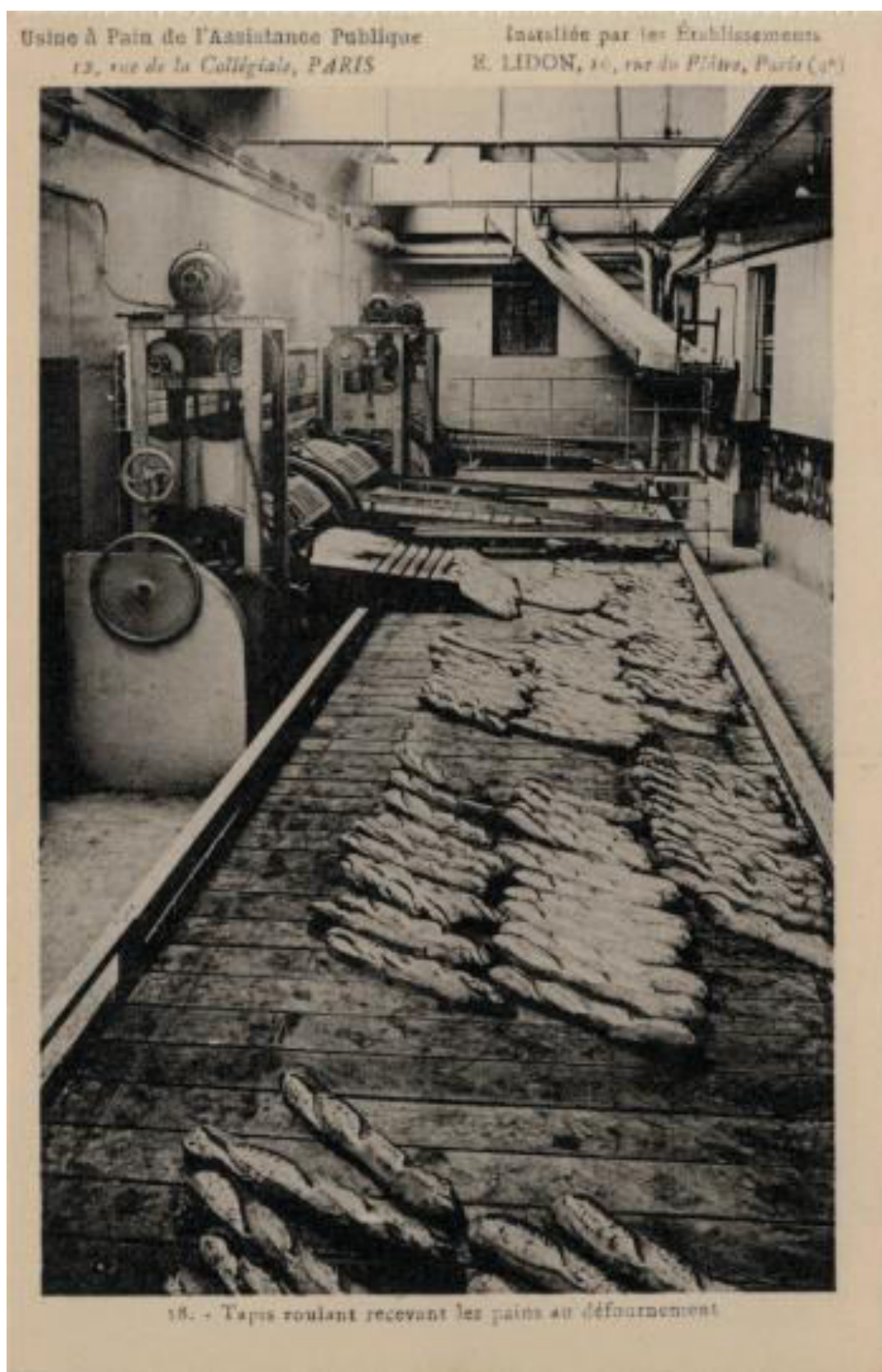
Figure 46 : Carte postale ancienne. Usine à pain de l'Assistance Publique, 12 rue de la Collégiale, Paris. Installée par les établissements E. Lidon, 10 rue du Plâtre, Paris (4e). 18 – Tapis roulant recevant les pains au défournement. © Coll. JP Martin.
