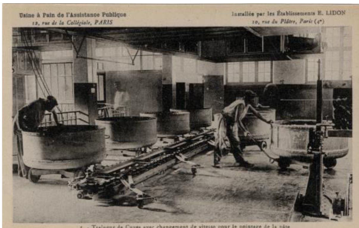
Figure 33 : Carte postale ancienne. Usine à pain de l'Assistance Publique, 12 rue de la Collégiale, Paris. Installée par les établissements E. Lidon, 10 rue du Plâtre, Paris (4e). 5 – Traîneur de cuves avec changement de vitesse pour le pointage de la pâte. © Coll. JP Martin.
