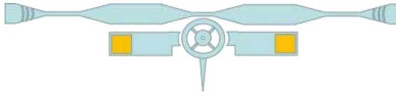
Figure 45 Pointes Olympia fabriquées sur substrat SOI
