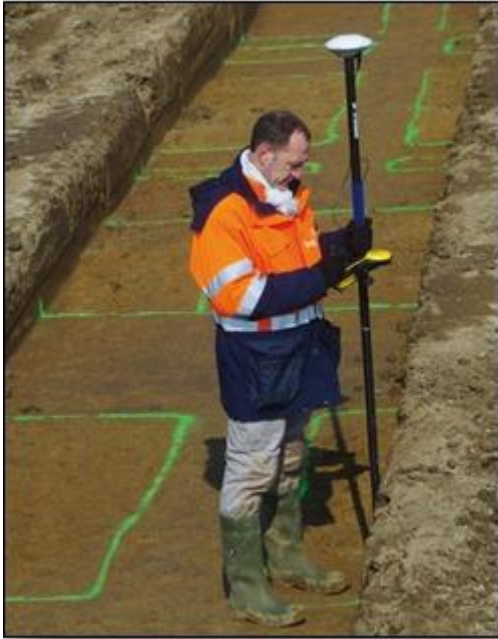
Figure 19 : Levé de points topographiques avec un appareil de géopositionnement sur un chantier de l'Inrap (© Denis Gaillard, Inrap)
