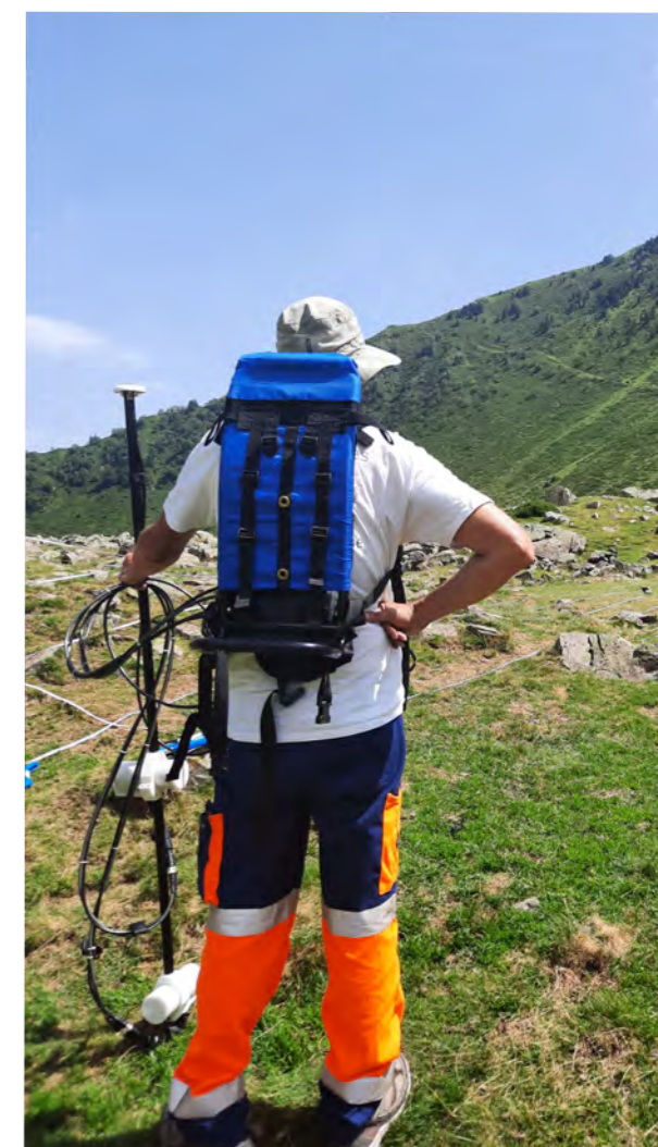
Fig. 23 - Montage du magnétomètre
