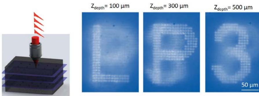
**Figure 3.** Inscription d'informations par trains d'impulsions lasers ultra-rapides (4 impulsions picosecondes à cadence THz) à différentes profondeurs dans un wafer de silicium. Les 3 images montrent la lecture par imagerie infrarouge ( $NA = 0.45$ , fond noir) d'inscriptions réalisées les unes au-dessus des autres à des profondeurs de 100, 300 et 500  $\mu\text{m}$  à l'intérieur du wafer. Les aberrations sont corrigées pour chaque plan (écriture laser et imagerie).
