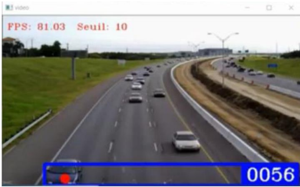
fig 5 : détection du nombre de véhicule dans une route
