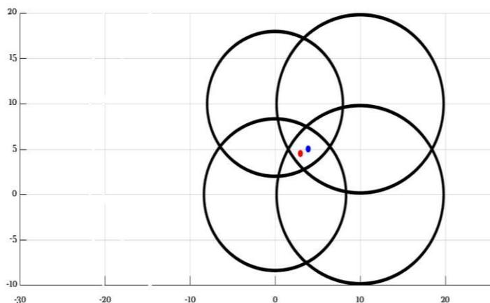
fig 2. L'estimation de localisation par la trilatération et l'exactitude de positionnement (unité: mètre)
