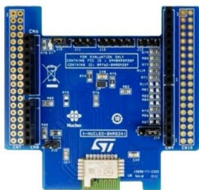
Fig. 4 : Photographie de la carte X-NUCLEO-BNRG2A1.
