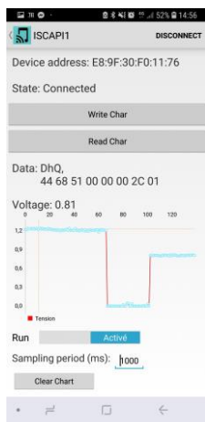
Fig. 12 : Affichage des tensions reçues avec une résistance R_1 de 5,6 k \Omega puis de 10 k \Omega .
