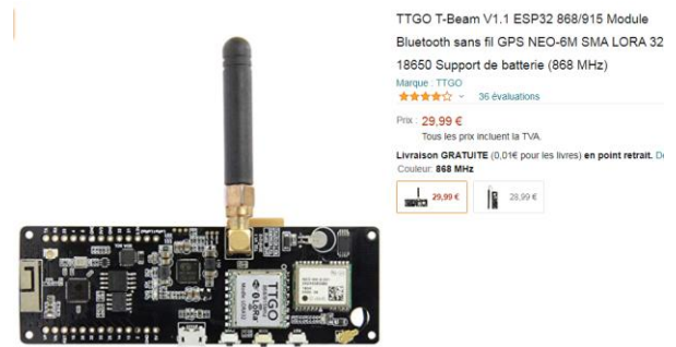
Fig 9. TTGO avec ESP 32 avec GPS, OLED et Lora intégré
