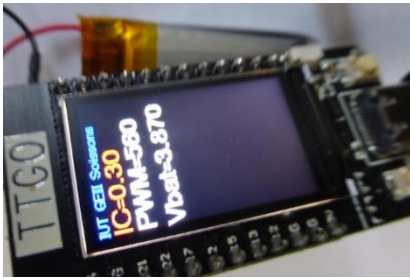
Fig 11. ESP 32 TTGO OLED batterie, GPS
