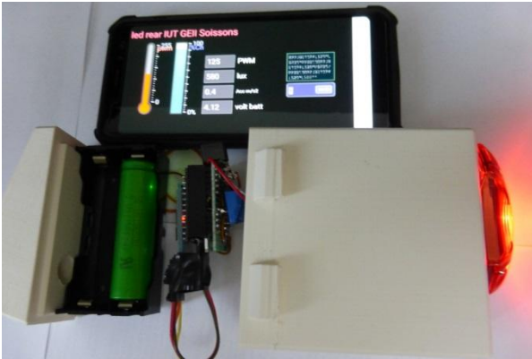
Fig 8. La réalisation avec communication par Bluetooth, pour paramétrer l'éclairage et vérifier la régulation
