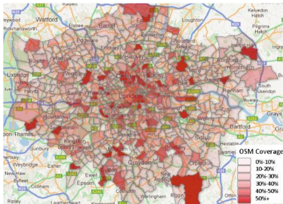
Figure 3 - La complétude des POI OSM comparés aux POI de Navteq , à l'échelle des wards du Grand Londres (Mashadi et al., 2015)
