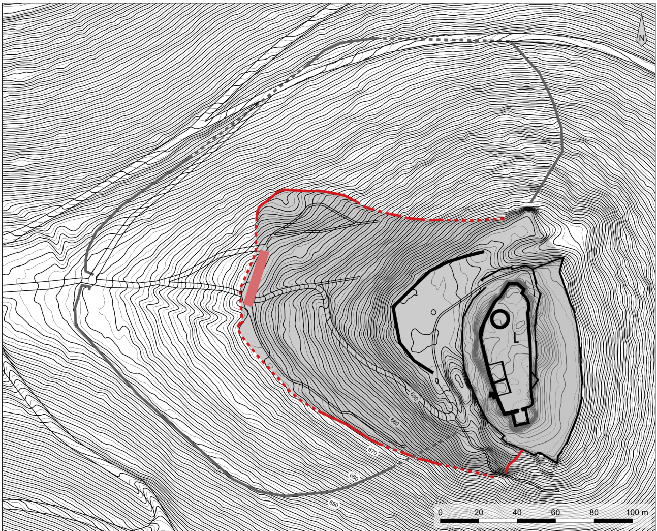
Fig. 62 : Plan des structures défensives romaines
