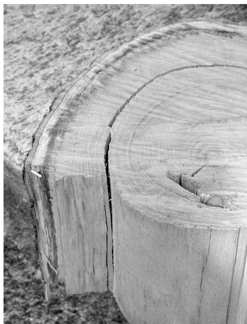
Photo 1 : La roulure est une fente parallèle au cerne qui évolue sur le plan longitudinal - tangentiel du bois. Photo P. Krebs
