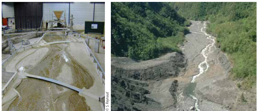
Figure 6.12. Exemple d'étude en modèle physique réalisé à la CNR : la rivière des Pluies (Île de la Réunion) : (a) photo du modèle, et (b) photo du prototype/nature.
