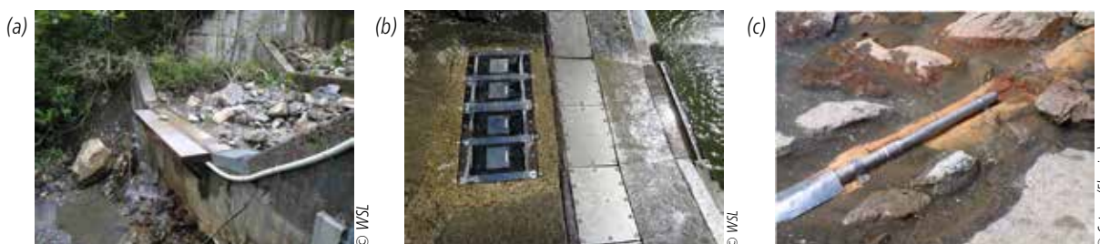
Figure 4.21. Plaques géophone sur le seuil du torrent Erlenbach en Suisse (a) avec les mini-plaques géophone (b) et tube géophone de type japonais sur le torrent Saldur en Italie (c).
