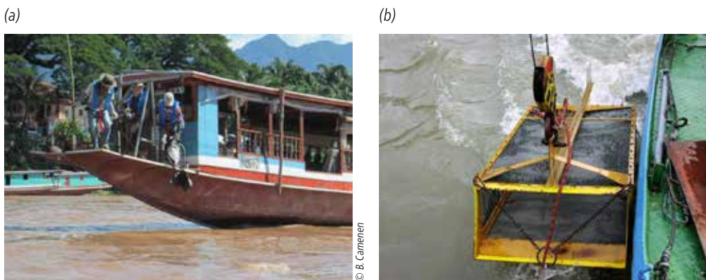
Figure 4.8. Exemples de jaugeage solide à partir d'un bateau sur le Mékong avec un HS 76 mm (a) ou sur le Danube avec un préleveur Ehrenberger (b).
