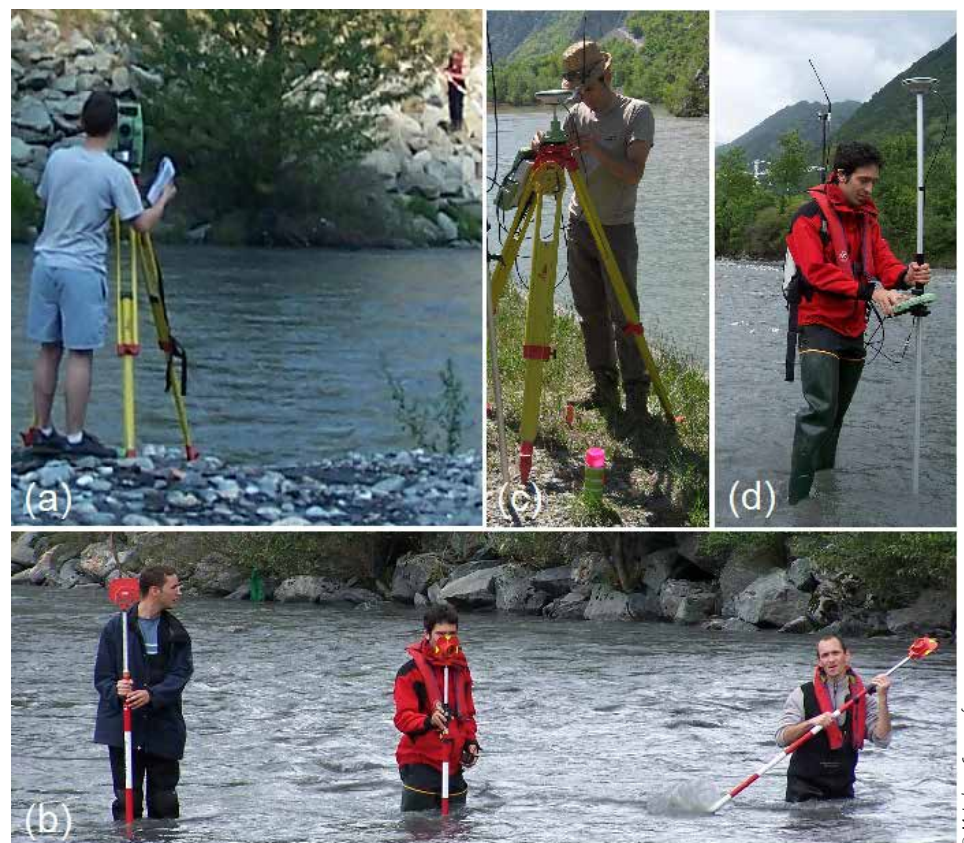
Figure 2.31. Déploiement pendant des campagnes topographiques (a) Station totale Leica TC305 et opérateur à la visée, (b) levé sur une section avec trois opérateurs munis de mires, (c) installation de la base dGPS (Leica system 1200), et (d) levé topographique avec le mobile dGPS du même système (Jodeau, 2007).
