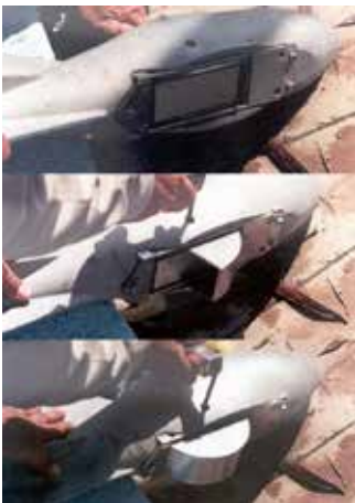
Figure 2.46. Photos de l'échantillonneur de fond US B-54 déployé depuis une potence de bateau (a) et expliquant le principe de fonctionnement (b).
