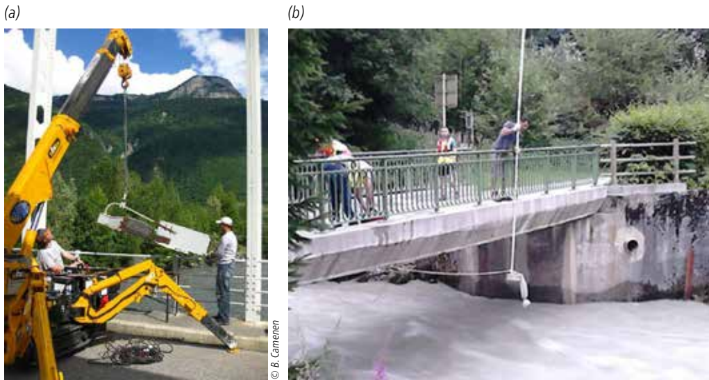
Figure 4.7. Exemples de jaugeage solide à partir d'un pont, en utilisant une grue (a) ou en utilisant une canne télescopique (b).
