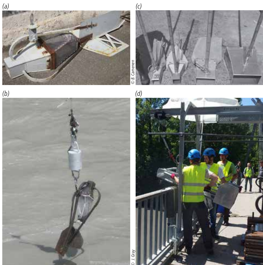
Figure 4.3. Préleveurs Helley-Smith d'ouverture 152 mm (a) et 76 mm (b), exemples de préleveur manuel de type Helley-Smith ou dérivé (d'après Gray et al., 2010) ; et préleveur Toutle River 2 (c) déployé depuis un pont sur l'Isère à Grenoble (mesure EDF opérée par Hydrogéosphère).
