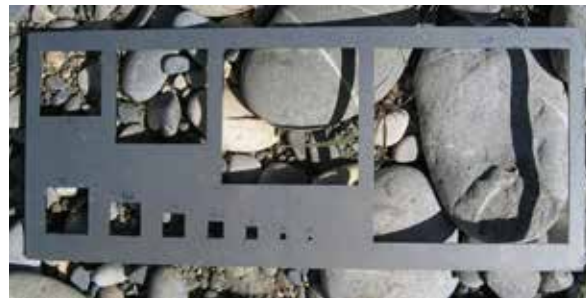
Figure 2.47. Gabarit de mesure granulométrique réalisé à partir du modèle FISP (Federal Interagency Sedimentation Project US SAH97). Les côtés des carrés mesurent 4 ; 8 ; 11,3 ; 16 ; 22,6 ; 32 ; 45,3 ; 64 ; 90,5 ; 128 mm.
