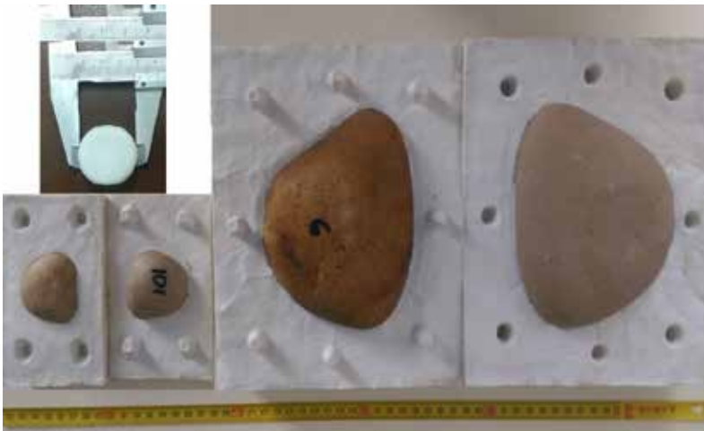
Figure 4.26. Vue en plan d'un RFID actif dans sa capsule (encart) et de particules artificielles dans leur moule.
