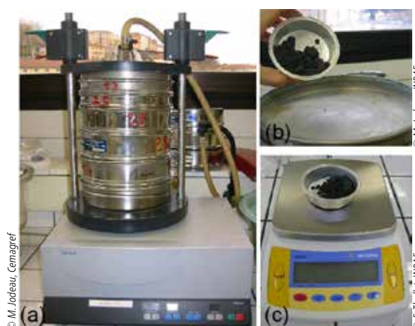
Figure 2.42. Granulométrie des sédiments fins par tamisage (Jodeau, 2007): (a) colonne de tamis, agitateur mécanique et circuit d'eau, (b) échantillon de sédiments fins, et (c) pesée (résolution 0,01 g).
