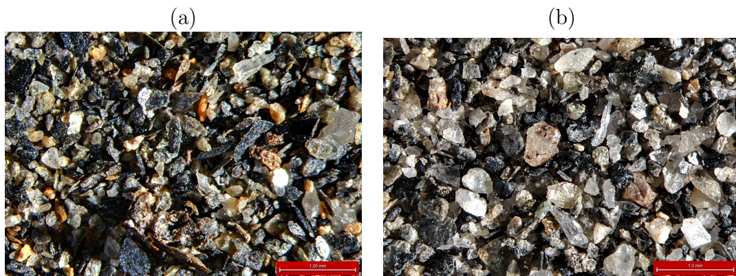
FIGURE 4.9 – Photographies au microscope de sables issus d'échantillons prélevés à la traïlle de Beaumont-Monteux avec (a) la bouteille de Delft le 2 février en sub-surface et (b) le préleveur US-P72 le 3 février à 2 m sous la surface.
