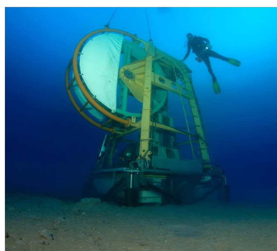
Les tiges sont enroulées sur une roue, enfouies dans le sédiment (pénétrateur Penfeld) puis les boîtiers électroniques TIPS sont connectées à une station de l'observatoire sous-marin EMSO-Ligure-Nice
