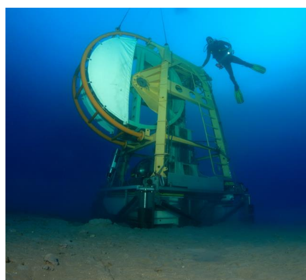
Les tiges sont enroulées sur une roue, enfouies dans le sédiment (pénétrateur Penfeld) puis les boîtiers électroniques TIPS sont connectés à une station de l'observatoire sous-marin EMSO-Ligure-Nice
