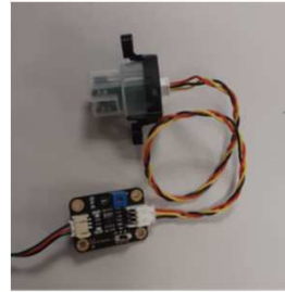
Capteur de turbidité SKU SEN0189, non étanche sensible au soleil
