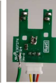
LED alimentée par un signal carré (0-3,3 V) Soustraction IR solaires
