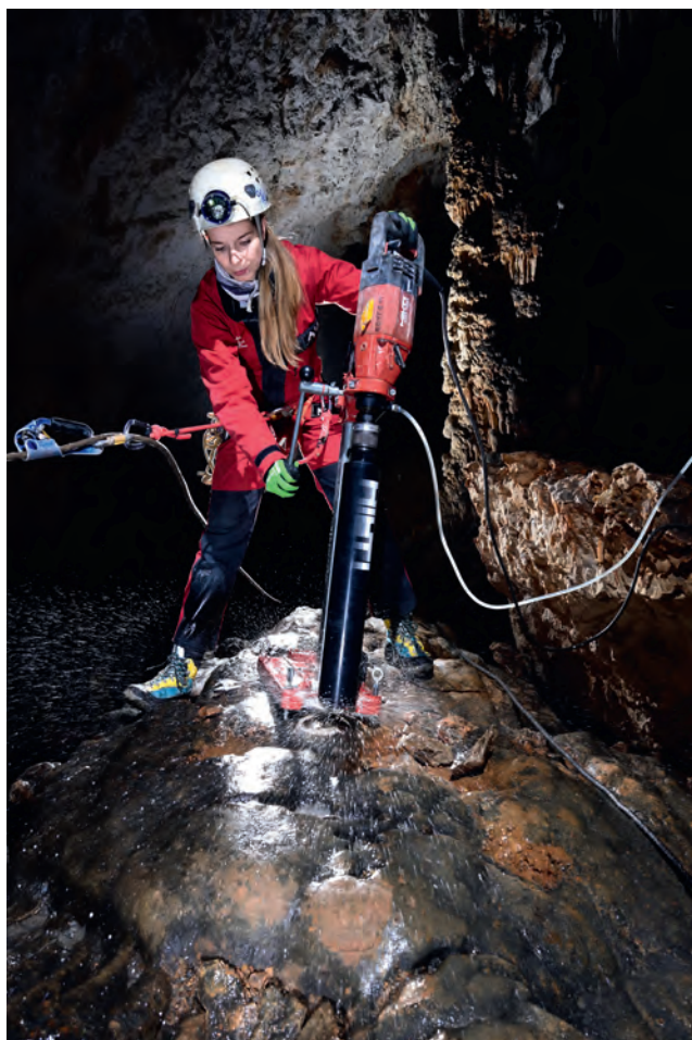
Carottage d'une grande stalagmite couchée, avec une tête 100 mm, dans la salle de Joly (aven d'Orgnac), lors de l'atelier « carottage souterrain 2021 » du réseau de métiers CNRS « Milieux Souterrains et Karsts ». Cliché Ph. Crochet.
