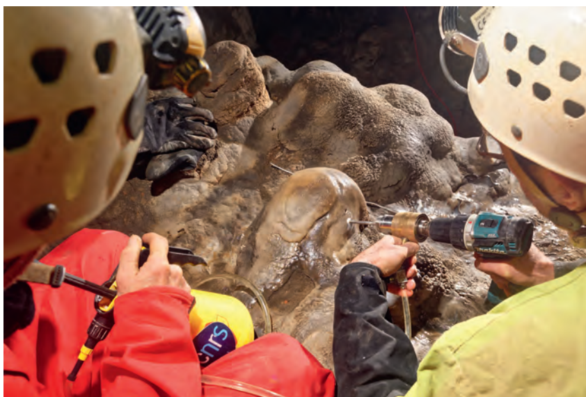
Test de carottier de petit diamètre (ici 4 mm) pendant l'atelier « Carottage souterrain 2021 ». Cliché S. Jaillet
