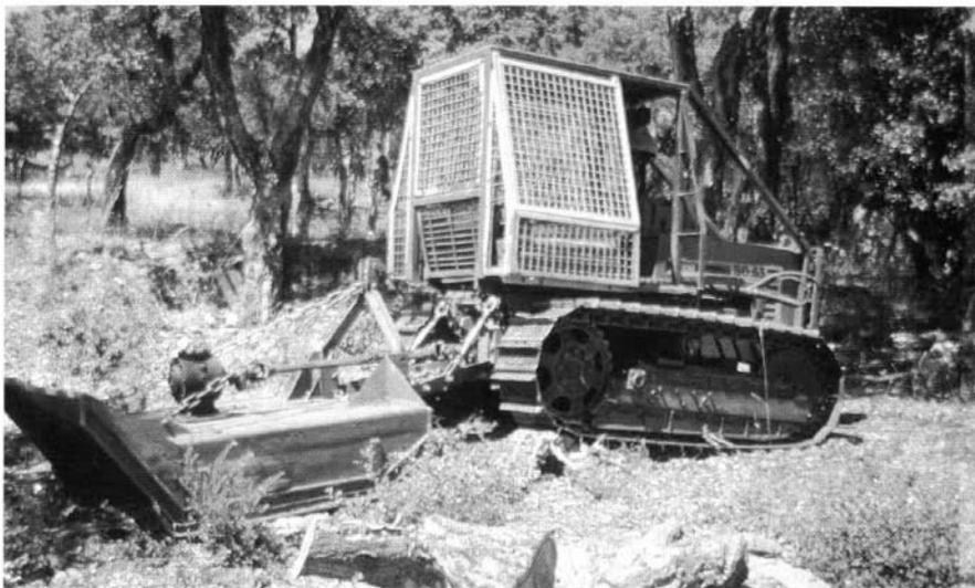
**Photo 5 : Broyeur à chaînes - Tracteur à chenilles.**
