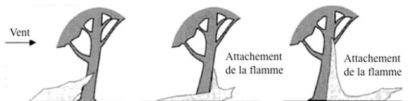
En raison du vent et du diamètre du tronc de l'arbre, la flamme s'attache au tronc en aval de ce dernier, augmentant le taux de combustion et le temps de résidence du feu
