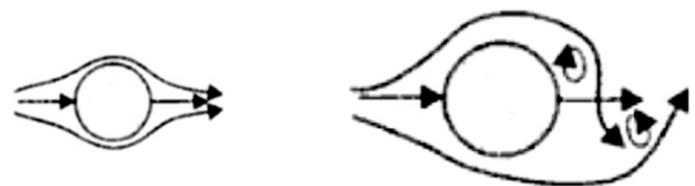
Petit d130 et vent faible : le sillage est « laminaire » et il n'y a pas d'attachement de flamme
