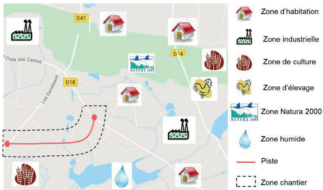
Figure 16 Exemple de cartographie d'identification des zones d'exposition
