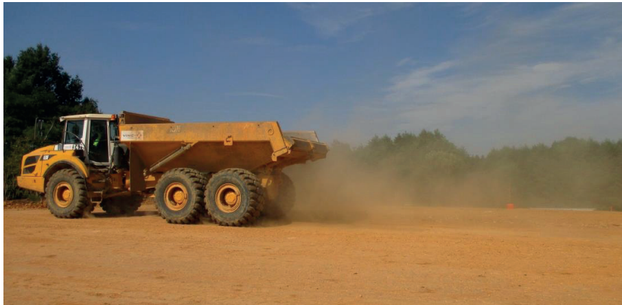
Figure 3 Envol des poussières suite au passage d'un tombereau
