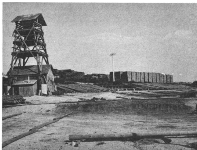
Photo 54. — Injection des poteaux de ligne (procédé Boucherie). Aumont-Aubrac. Photo M.C.-C.R.P.F.
