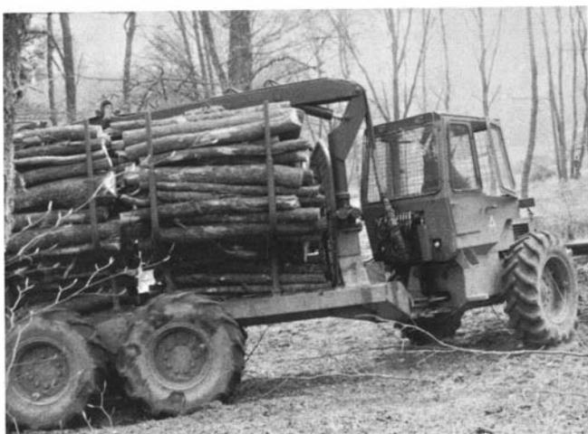
Photo 12. - Tracteur porteur à châssis long monté sur boggie à 2 essieux fixés sur palonnier - grue à longue portée - adaptée au chargement en long - articulation centrale - lame avant (SIFER).
