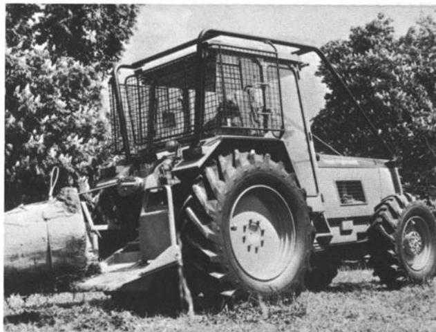
Photo 8. - Tracteur forestier débusqueur à 4 roues motrices type agricole transformé en forestier : Treuil - bouclier - cabine protégée - arceau de protection et d'écartement des branchages : Renault-Cemet SM 255 de 65,5 kw, à châssis rigide.
