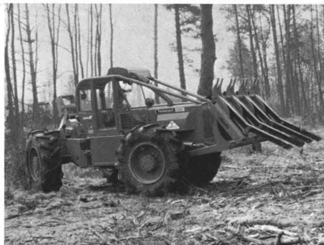
Photo 6. - Rateau débroussaillieur et éventuellement dessoucheur - niveleur fixé à la place du bull sur tracteur forestier débusqueur à articulation centrale et treuil à l'arrière (Timberjack super E).
