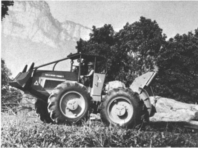
Photo 9. - Tracteur débusqueur - Skidder : 4 roues motrices égales, articulation centrale, treuil, lame avant, protection du conducteur : Renault-Cemet SM 368 C de 85,4 kw.
