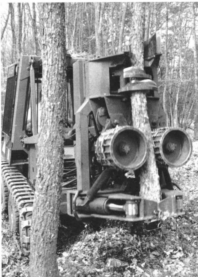
Photo 7. - tête d'abattage avec sécatteur hydraulique, diabolos de fixation et de guidage, pince de fixation (Makeri).
