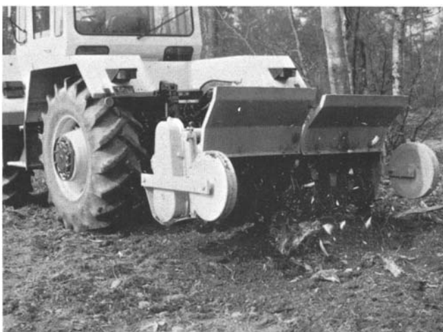
Photo 4. – Les houes rotatives renforcées débroussaillent et incorporent au sol la couche superficielle d'humus (Rotadairon). Photo Jean GUIGNARD
