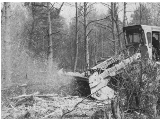
Photo 5. – Débroussailleur à rotor à axe horizontal, porté sur bras hydraulique frontal qui peut débroussailler et déchiqeter la végétation (Hydro-AX).
