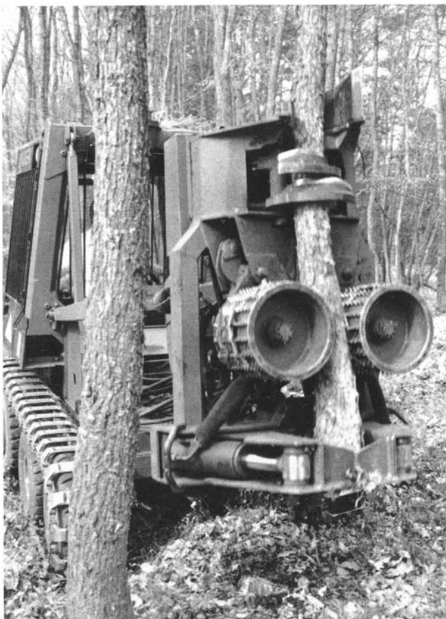
Photo 7. — tête d'abattage avec sécateur hydraulique, diabolos de fixation et de guidage, pince de fixation (Makeri).
