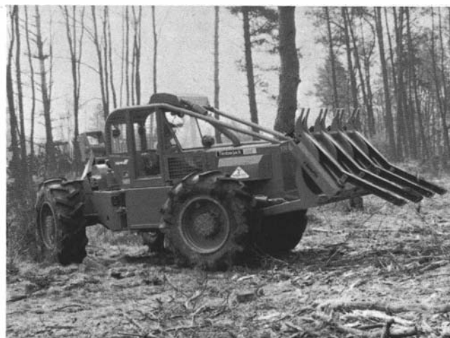
Photo 6. - Rateau débroussaillieur et éventuellement dessoucheur - niveleur fixé à la place du bull sur tracteur forestier débusqueur à articulation centrale et treuil à l'arrière (Timberjack super E). Photo Jean GUIGNARD
