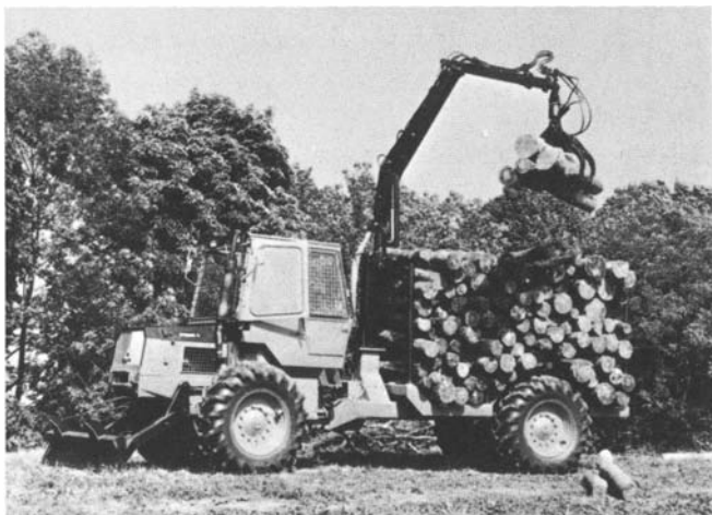
Photo 11. - Tracteur porteur articulé de 76,5 kW à 4 roues motrices égales grue chargeuse hydraulique manœuvrée de la cabine : Renault-Cemet SM 845.
