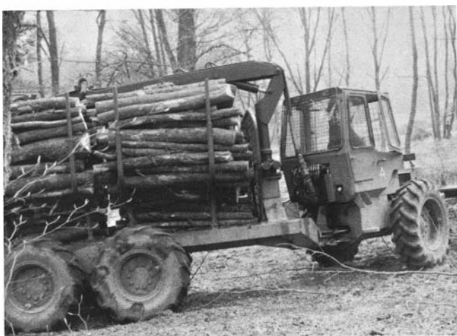
Photo 12. - Tracteur porteur à châssis long monté sur boggie à 2 essieux fixés sur palonnier - grue à longue portée - adaptée au chargement en long - articulation centrale - lame avant (SIFER). Photo Jean GUIGNARD
