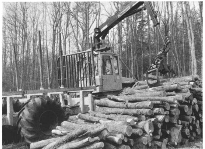
Photo 10. - Tracteur porteur à plateau surbaissé, à chargement en travers ou en long cabine protégée - Articulation centrale 4 roues motrices égales : Brimond avec grue canal).
