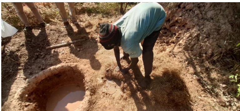
Pétrissage du mélange de fibres et de barbotine
