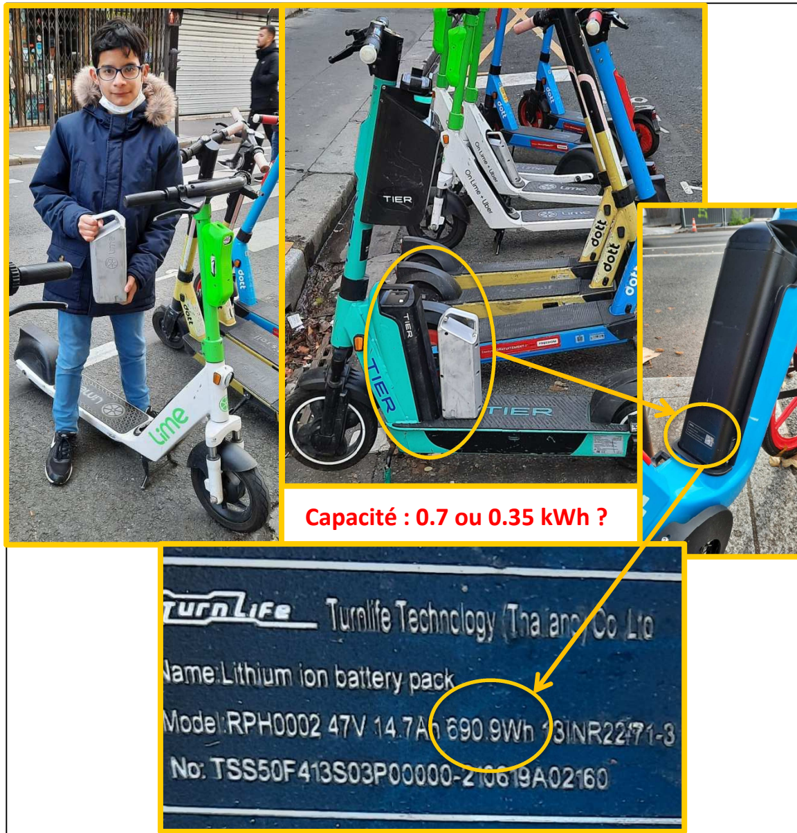
Fig.3 : Batteries des services Lime et Tier à Paris fin 2021. (Source : auteur)
