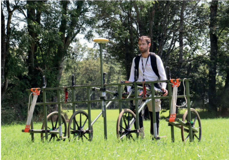
Figure n°21. Système d'acquisition magnétique à 5 sondes (MXPDA – Sensys) poussé devant l'opérateur.
