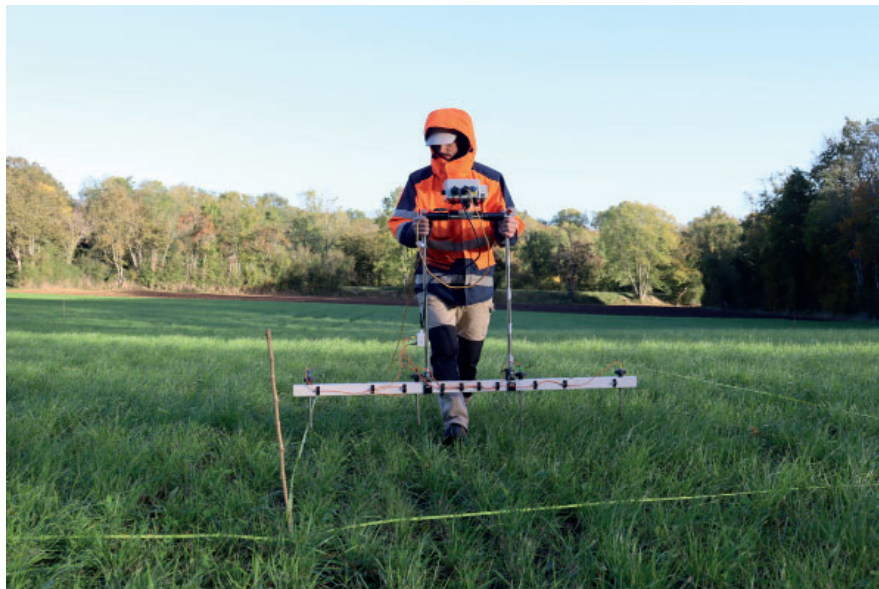
Figure n°23. Photo du RM85, système de mesure de la résistivité.
