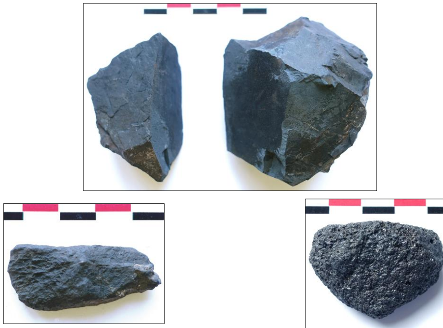
fig. 78, 79, 80 : La magnétite trouvée sous les trois formes
