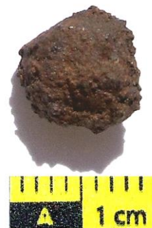
fig. 93 : Un grain de forge en fer
