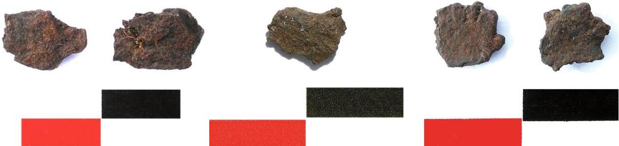
fig. 94, 95, 96 : Quelques lamelles de martelages
