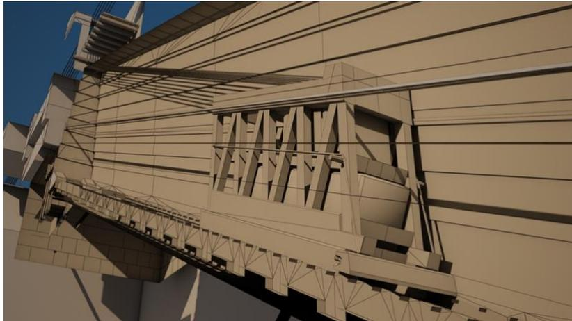
Fig. 16. Modélisation 3D du contrepoids circulant dans la Grande Galerie (Houdin J-P, Dassault Systèmes)
