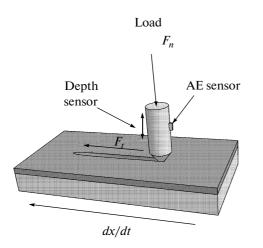
Fig. 1. Scratch-test pattern.
