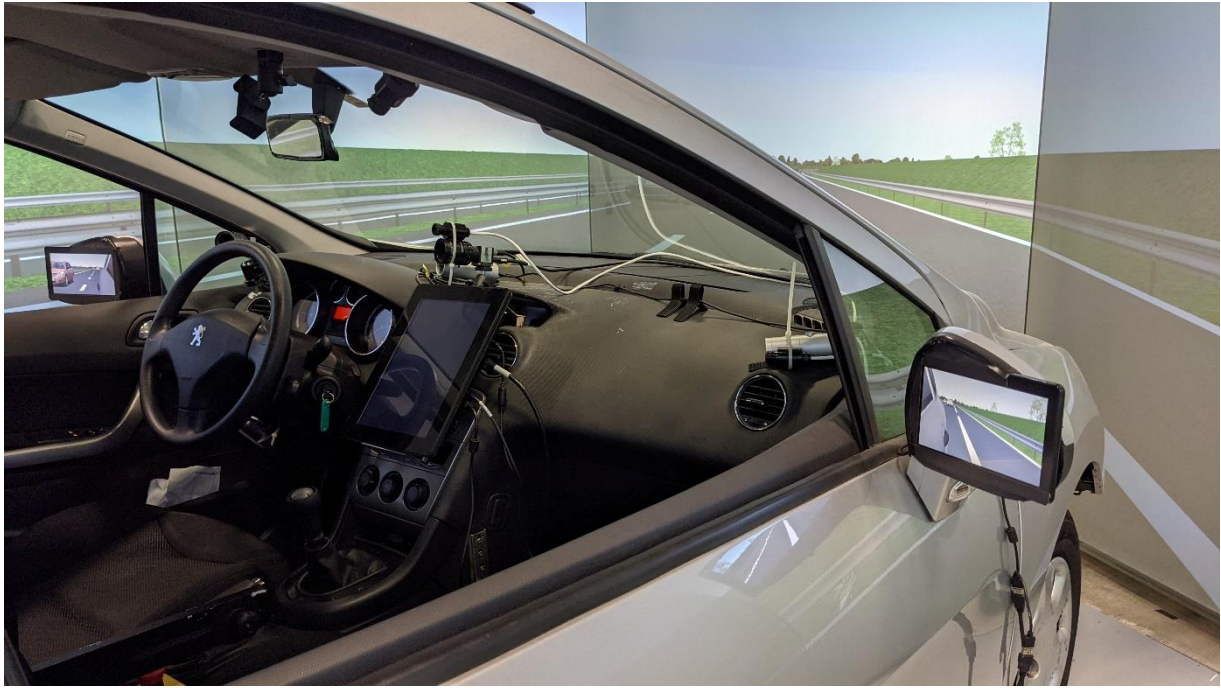
Figure 5 : Ecrans incrustés dans les rétroviseurs.
