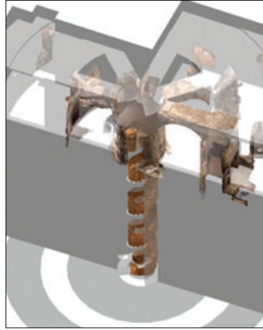
FIG. 8 b. – Relevé des structures avec l'escalier hélicoïdal interne (N. André, IRAA-CNRS).
