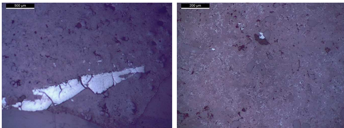
Figure 7.12 : Images au microscope métallographique polarisant en lumière réfléchie de l'échantillon PIG_0232_A_401. L'image de gauche témoigne d'une veine d'oxydes de fer qui, dans le cas présent a comblé une veine de calcite recristallisée. L'image de droite permet, quant à elle, d'observer des inclusions de sulfate de fer (pyrite), pointés par la flèche. Les autres parties métalliques observées forment un "réseau" au sein de la matière correspondent encore à des oxydes de fer. Photographies : M. Rossi
