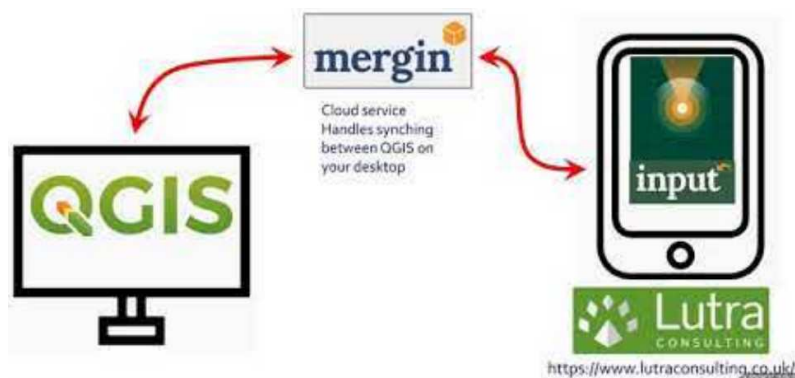
Figure 5.3 : Schéma du fonctionnement de Mergin . Schéma : Community Health Maps
