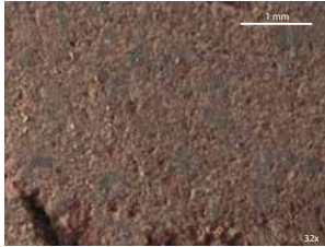
Figure 5.20 : Vues à plusieurs grossissements des surfaces abrasées avec des voiles abrasifs, du plus grossier P80 au plus fin P400. DAO : I. Querenet Onfroy de Breuille
