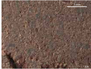
Figure 5.20 : Vues à plusieurs grossissements des surfaces abrasées avec des voiles abrasifs, du plus grossier P80 au plus fin P400. DAO : I. Querenet Onfroy de Breuille
