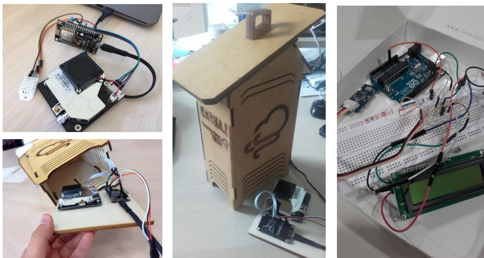
Figure 5. Photographie d'un capteur Luftdaten avec un boîtier Edulab et la boîte (source : wiki-Rennes)
