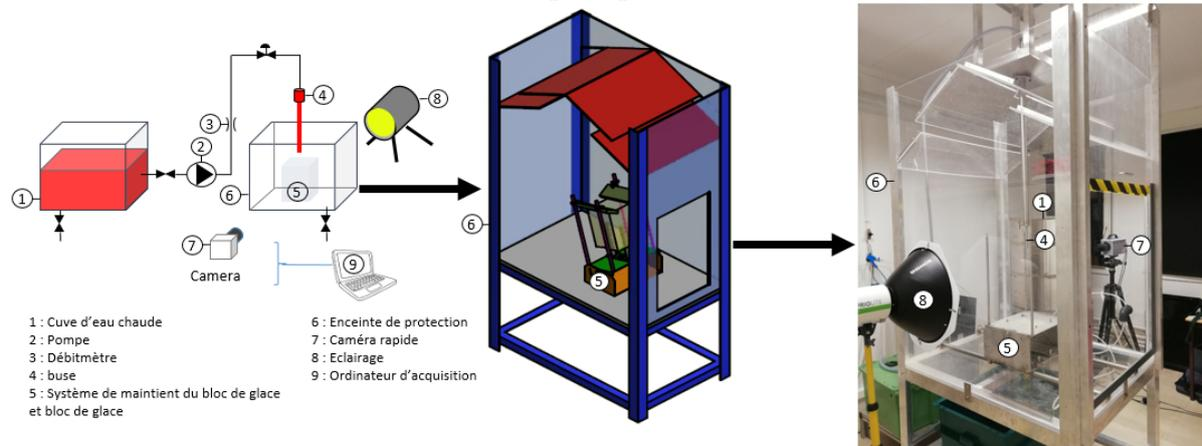
Pour obtenir de la glace transparente, il est important d'assurer une solidification directionnelle et d'empêcher la formation de bulles sur le front de solidification. Dans le but de déterminer la température initiale du bloc de glace des thermocouples seront pris dans le bloc. Seront aussi pris dans le bloc, des dispositifs de maintien (visibles sur la photographie reproduite en figure (5)).
